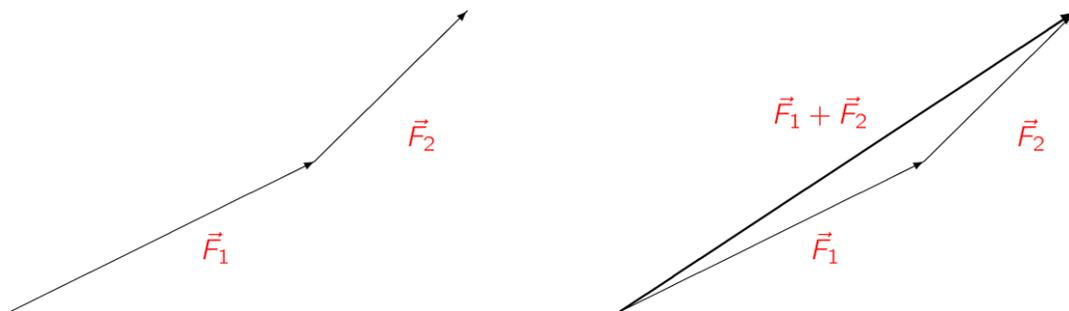
Es gilt:  $\vec{F}_1 + \vec{F}_2 = \vec{F}_2 + \vec{F}_1$ , d. h., die Vektoraddition ist kommutativ. Daher kann man die Vektoraddition von **zwei Vektoren** auch als Vektorparallelogramm darstellen:
