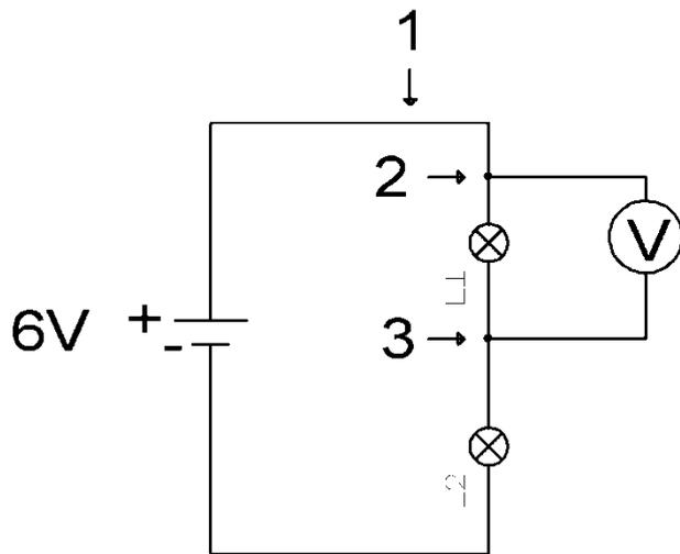
Für die Spannungsmessung darf **kein** Leitungsstück entfernt werden!!
