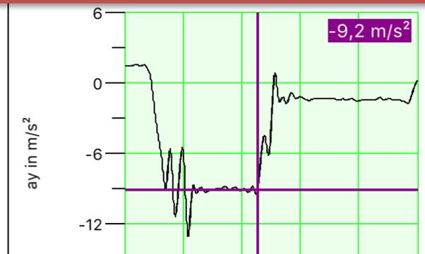
Achterbahn verlässt nach ca. 45 Sekunden die waagerechte Ebene. Bis zu diesem Zeitpunkt sind die Messwerte gut, da die Achterbahn sich auf einer Ebene bewegt und Messung (schiefe) Ebene gewählt wurde. Danach kann Messwerte wegen Neigung nicht mehr verwenden
